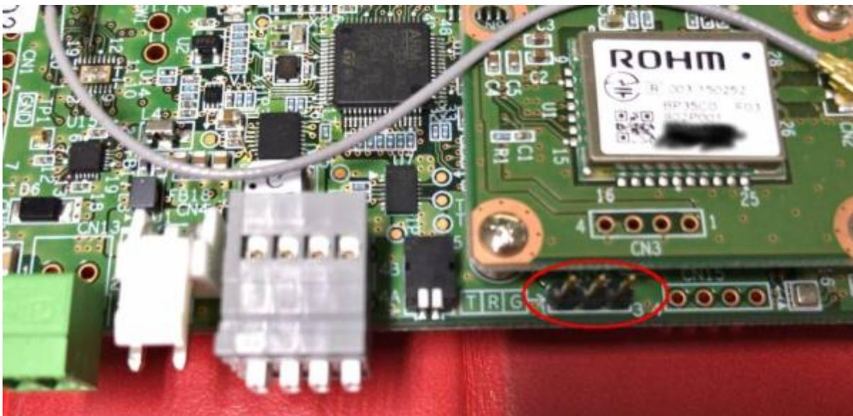
写真の **赤** で囲んだ部分がコンソール接続用のピンヘッダになっています。ピンアサインは左にあるシルクのとおり、左から TxD, RxD, GND となっています。
