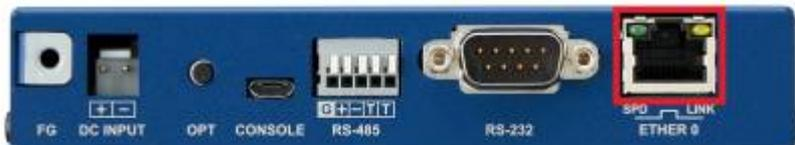
1. 本装置の ETHER0 と LAN ケーブル LAN ケーブルと PC を接続します。
