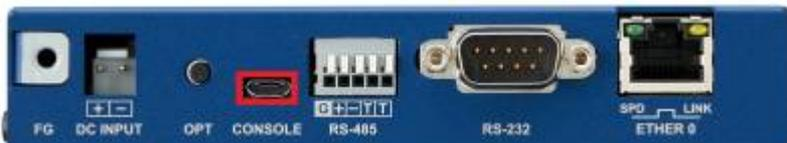
1. 本装置前面の CONSOLE ポート<sup>1)</sup>にUSBケーブルを接続させます。
