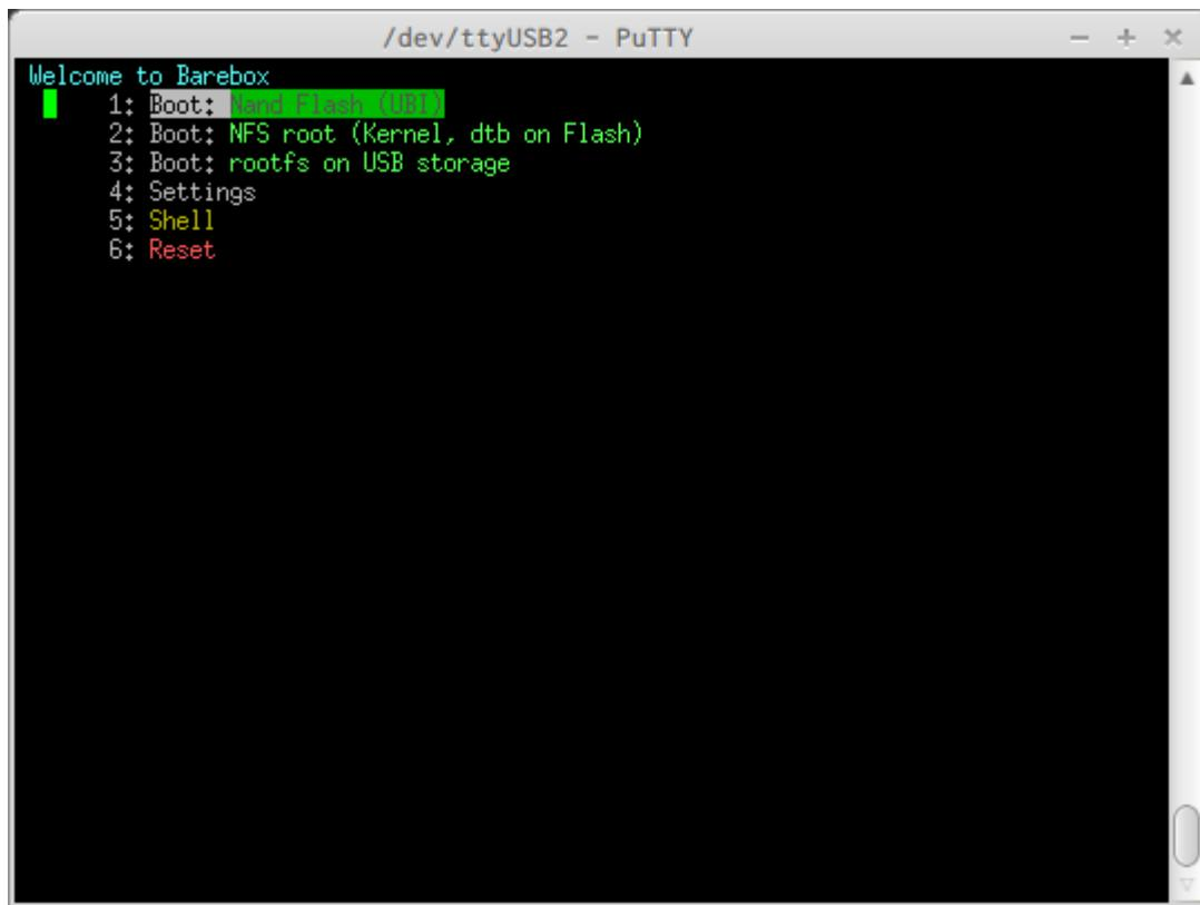
DIPSW設定を“bootloader menu”(参照: [ブートデバイスの選択およびコンソールの切替 \(DIPSW 設定\)](#))で起動するか、自動起動を停止させた後で“exit”と入力することでメニュー画面へと遷移します。
