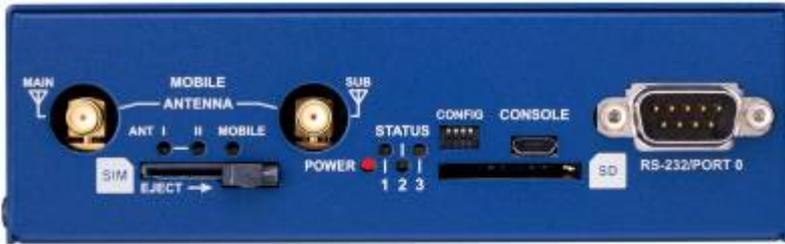
OPT Switch を押して頂くか、キャパシタの電荷切れるまで待つて頂くとPOWER LED が消灯します。この状態で電源ケーブルを刺すと本装置は起動処理を開始します。
